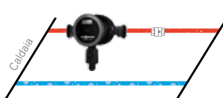
Pompa circolazione acqua impianto
